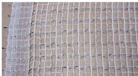
↑ 炭素繊維を編み込んだ面状発熱ネット (平成24年度富山県トライアル発注認定商品)
